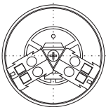
Einphasiger Kondensator mit d = 60/70 mm
