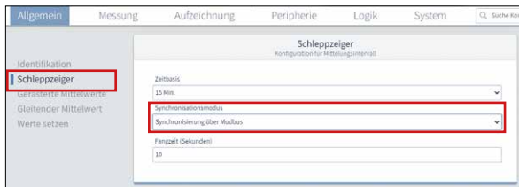
Abb. Schleppzeiger-Konfiguration in der Software GridVis®
