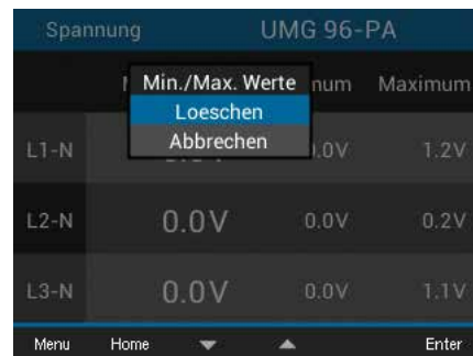
Abb. Messwertanzeige Spannung L-N mit Menü Min.-/Max.-Werte Löschen/Abbrechen
