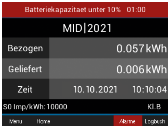
Abb. Warnhinweis „Batteriekapazität unter 10%“
