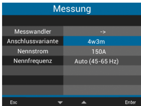
Abb. Fenster Messung mit den Einträgen zu den Messwandlern
